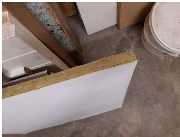
Déclaré - : RDC / WC 1 - Faux plafond- (Absence d'amiante)
